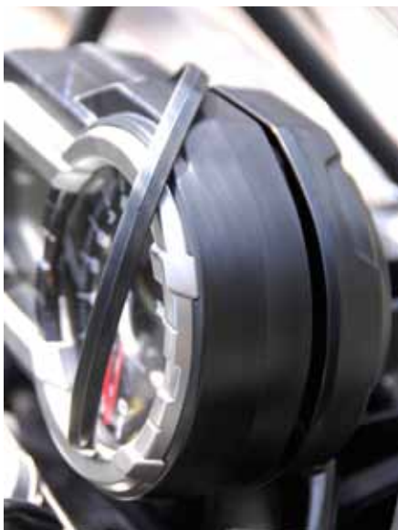
Auflösungserscheinung: Die Dichtung des Tachogehäuses machte sich selbstständig. (Fotos: Lenzen)
