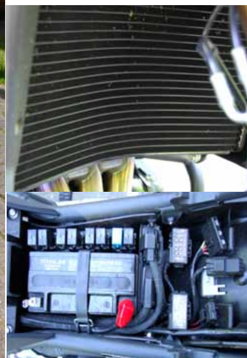
Eine markante Erscheinung ist die Explorer auch von vorne. (l.) Der Öhlkühler ist ungeschützt (o.). Gut aufgeräumt und leicht zugänglich präsentiert sich die Elektrik unter der Sitzbank. (Fotos: Lenzen)
